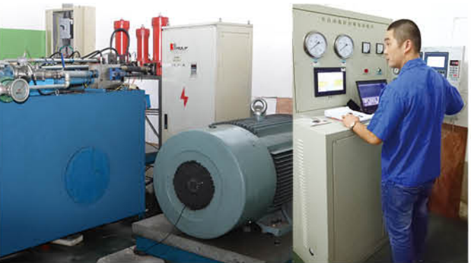
电机功率250KW 转速3000r/min 超大功率叶片泵全自动测试平台 Full automatic testing bench for vane pump with 250KW motor power and 3000R/M speed
